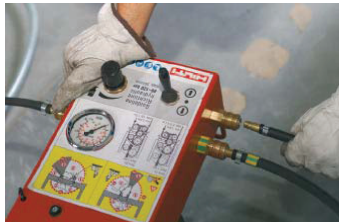
コンプレッサーホースをコントロールパネルに接続
